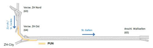
Gleichzeitig soll der Pannenstreifen im Bereich Zürich-Ost (Rampe von der Stadt Zürich in Fahrtrichtung St. Gallen) zu einem zusätzlichen Fahrstreifen umgenutzt werden. Die PUN soll auf der linken Seite der Stammfahrbahn N01 weitergezogen und nach ca. 800 m vor dem Anschluss Wallisellen abgebaut werden.
