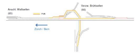
Massnahme M4a und M4y, Bereich Zürich-Ost, Fahrtrichtung St. Gallen: Im Bereich der Verzweigung Zürich-Ost soll der Pannenstreifen auf der Rampe Bern zu einem permanenten Fahrstreifen umgenutzt werden. Aus Richtung Stadt Zürich soll dagegen die rechte Rampe nicht mehr als durchgehender Fahrstreifen (Spuraddition), sondern als Einfahrtspur von rechts geführt werden.
